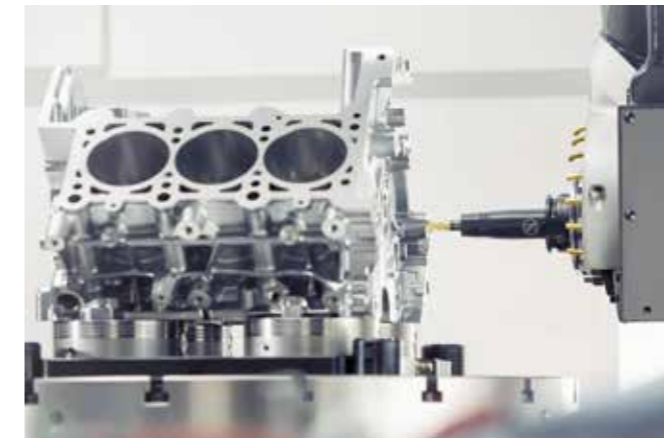
Lavorazione di una testata cilindro motore TENDO Slim 4ax
