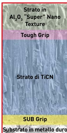
..... Strato in  $\text{Al}_2\text{O}_3$  con un'eccellente resistenza all'usura.
