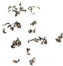
Con frequenza di vibrazione controllata = 1.25/giro
