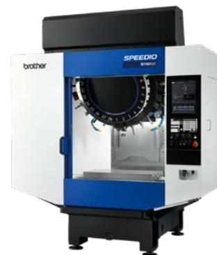
Velocità massima del mandrino 10000 min<sup>-1</sup>, Motore mandrino 26.2 kw, Coppia 92 Nm
