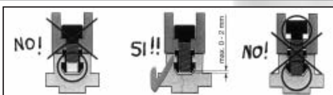
ESEMPIO CORRETTO DI MONTAGGIO DELLE VITI FRA MORSETTO E TASSELLO
